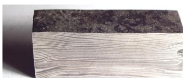
Olajedzett 160 rétegű C45 + 90MnCrV8
