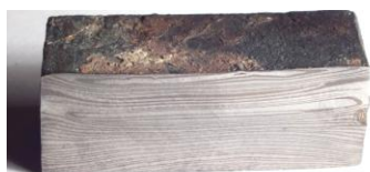
Lágyított 160 rétegű C45 + 90MnCrV8
