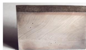
Vízedzett tűzcsiholó darab 90MnCrV8 + 40 rétegű csavart S235 + 90MnCrV8
